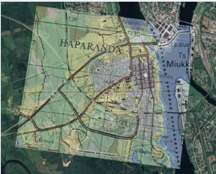
Bild 3. Då klippet dimmas framgår att järnvägen i överkant och vägen i vänsterkant inte ligger helt rätt – trimning behövs (öka bredd, minska höjd, vrid något moturs)!
