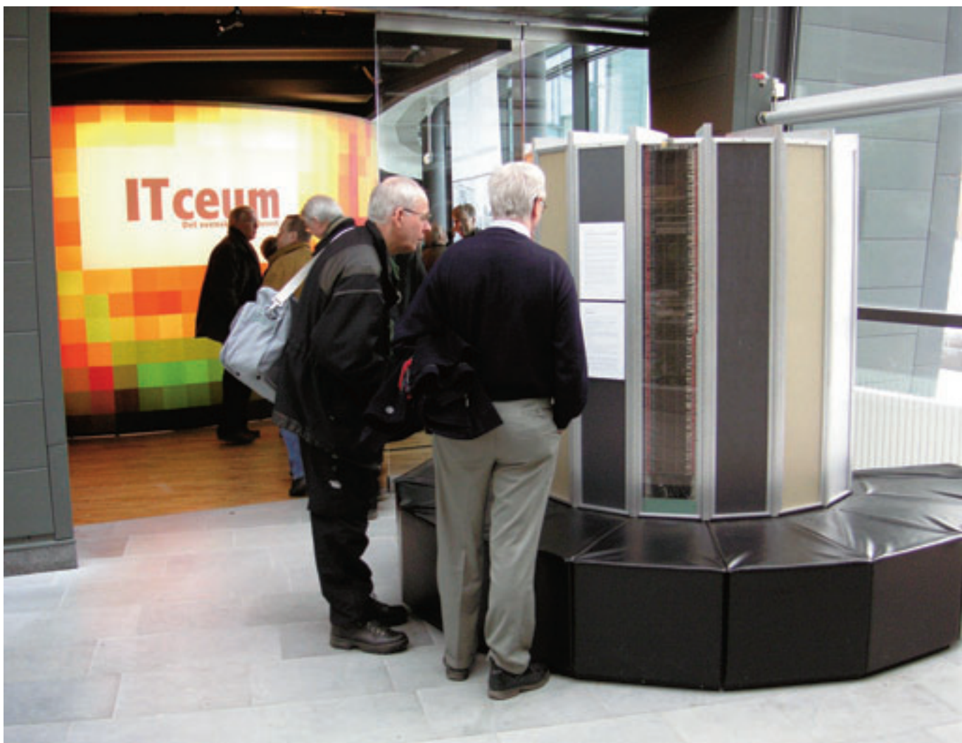
Entré med soffor för besökare? Nej, en Cray superdator från 80-talet. Effektförbrukning 150 kW, vikt 4.8 ton.
